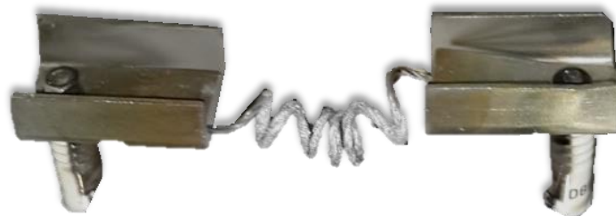
Figura 2.1. Filamento de evaporación empleado experimentalmente. En este caso, se encuentra bañado en aluminio.
