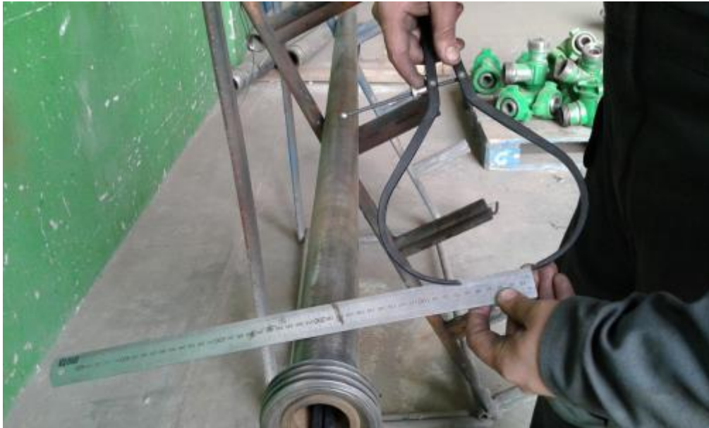
Lectura de la medición del diámetro exterior con calibre
