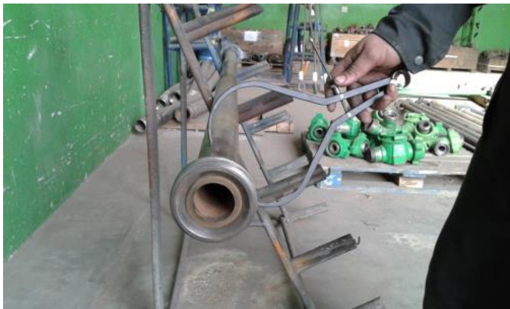
Medición de diámetro exterior con compás
