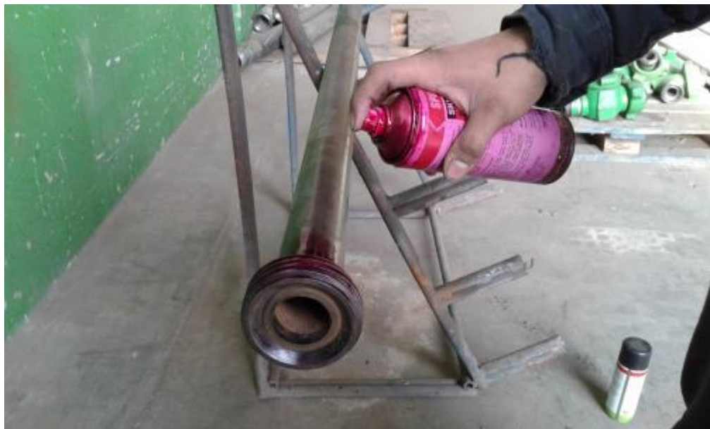
Ensayo de líquidos penetrantes realizado a componente de alta presión
