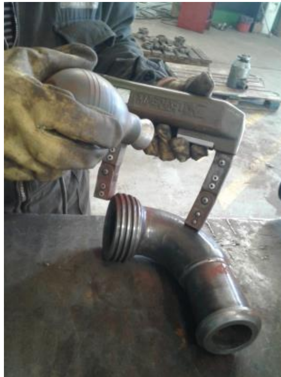
Ensayo de partículas magnéticas realizado a componente de alta presión
