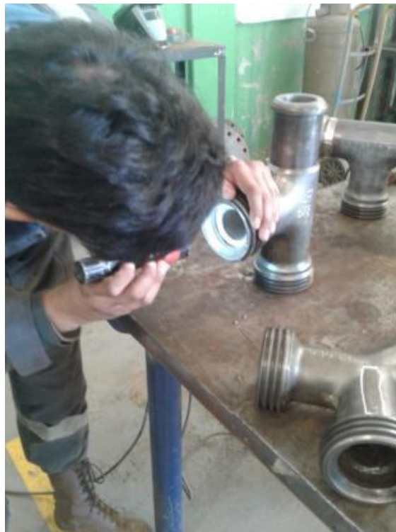
Inspección visual realizada a componente de alta presión
