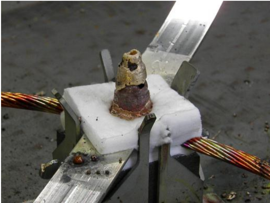
Figura 2.10 Impacto de la humedad en la soldadura cuproaluminotérmica: formación nido de avispa en la soldadura.
