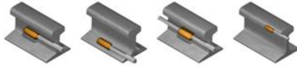
Figura 2. 4 Soldadura cuproaluminotérmica realizada en la industria ferroviaria
