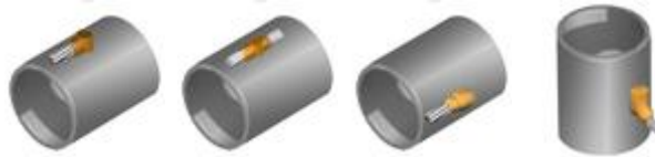
Figura 2. 7 Soldadura cuproaluminotérmica para protección catódica.
