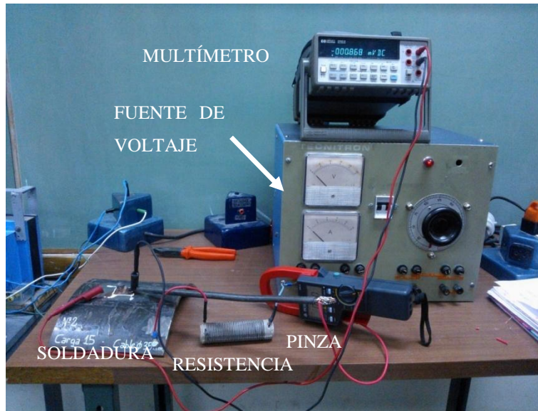
Figura 3. 3 Circuito eléctrico armado para la medición de las resistencias de las soldaduras.
