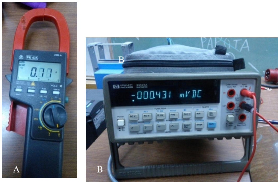
Figura 3. 4 Equipamiento utilizado A) Pinza amperométrica; B) Multímetro HP Hewlett Packard.
