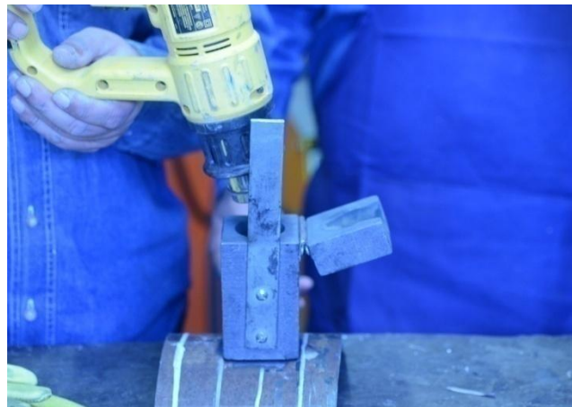
Figura 3. 2 Secado del crisol con una pistola de calor.
