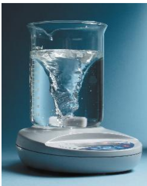
Figura 18: Representación del vórtice necesario para el agregado de polímero
