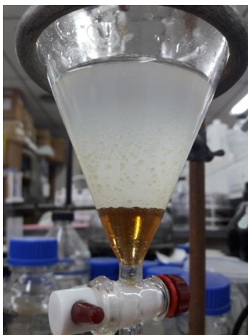
Figura 14: Método de extracción Líquido-Líquido en ampolla de decantación.
