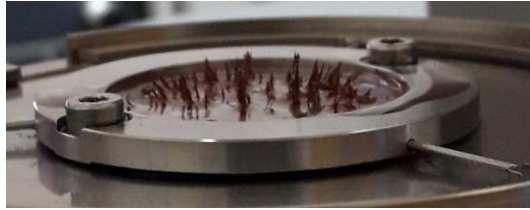
Figura 25: Disposición de las partículas PM luego de la medición reológica del MMPM con la aplicación de un campo magnético de 2A.
