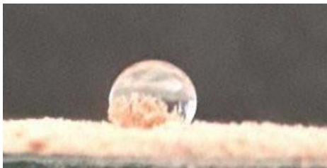
Figura 6: Gota de agua depositada sobre las partículas magnéticas modificadas para evaluar el ángulo de contacto.
