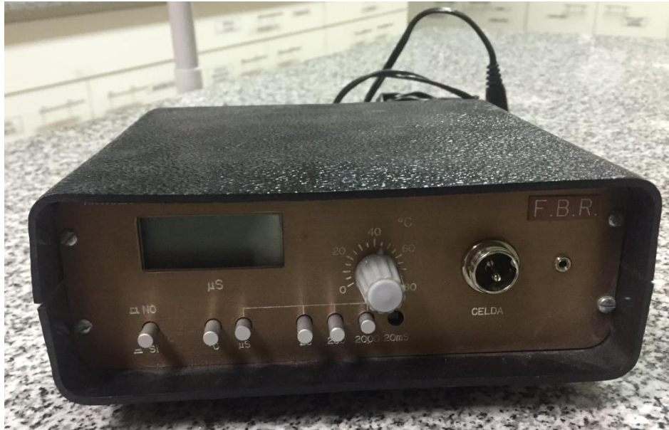
Figura 3.3.5.1. Medidor de conductividad PARSEC ANTARES IV .
