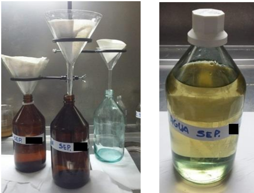
Figura 3.1.1.2. Disposición de los elementos de filtrado (der.) y agua con bajo contenido de hidrocarburo y sólidos en suspensión.
