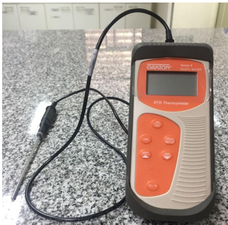
Figura 3.3.4.1. Termómetro digital ACORN TEMP 6 RTD.
