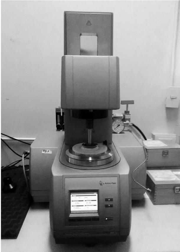
*Fig. N° 14: Reómetro Anton Paar MC 302*
