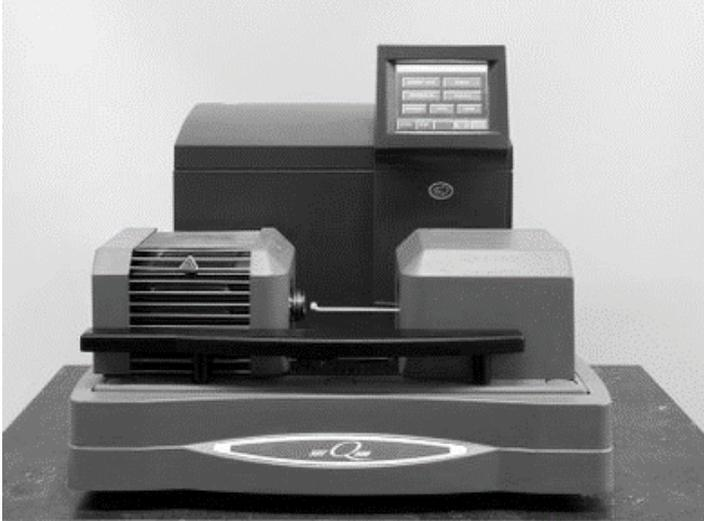
Fig. N° 9: Equipo de análisis térmico simultáneo TA SDT – Q600
