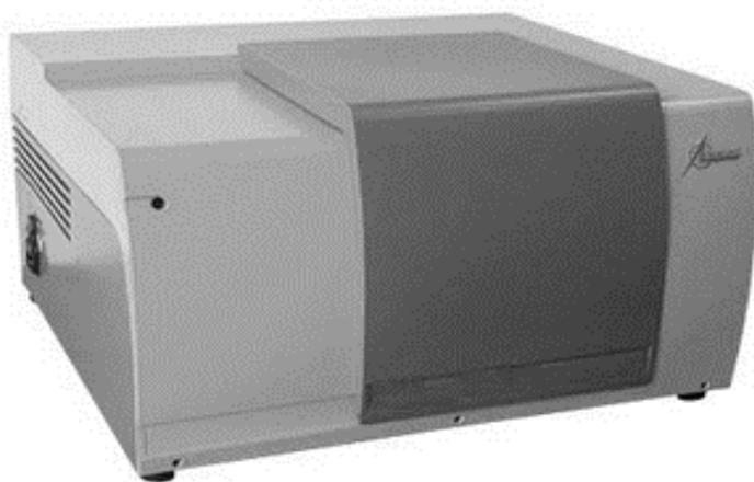
*Fig. N° 11:* Equipo InfraLUM FT-08 utilizado para la medición de espectroscopía IR
