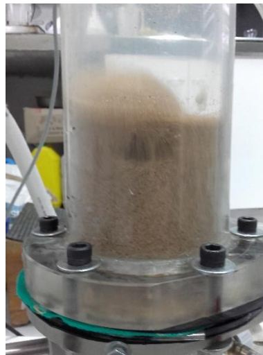
Figura 4.3 - Burbuja en el tope del lecho de arena durante la fluidización.
