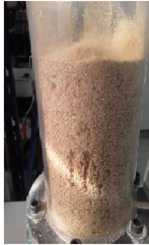
Figura 4.5- Biomasa durante el régimen de fluidización comprendido entre U_{if} y U_{cf} .
