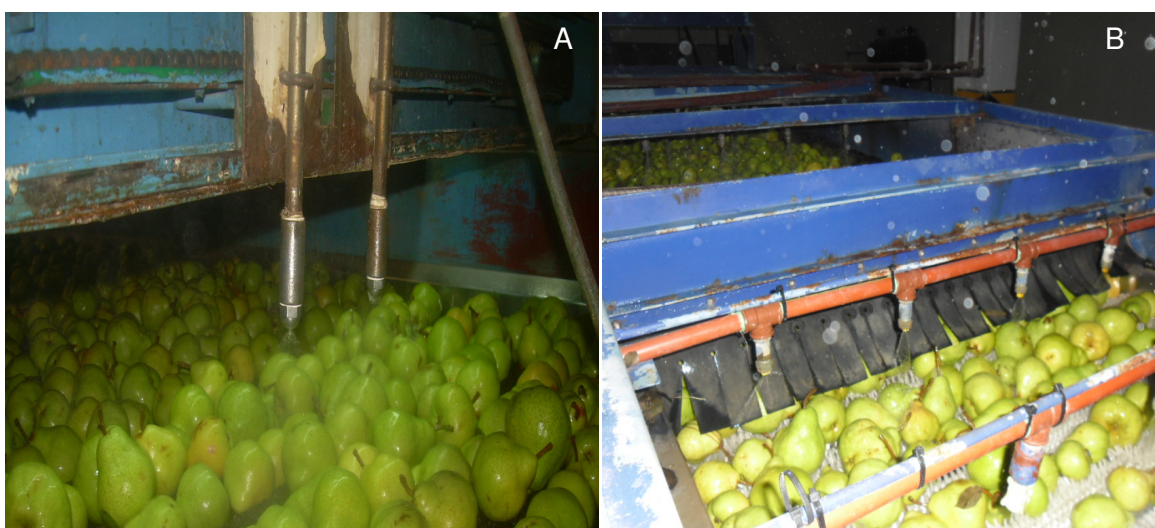
Figura 1. Sistemas de aplicación utilizados en los empaques. A) Toberas de aplicación corredizas, adaptación del sistema aplicador de cera, empaque A. B) Conductos tradicionales de aplicación con toberas pulverizadoras, empaque B.
