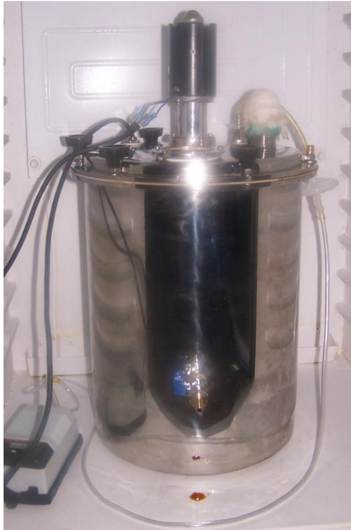
Figura. Biorreactor de acero inoxidable utilizado para la producción de biomasa de las levaduras antagonistas.
