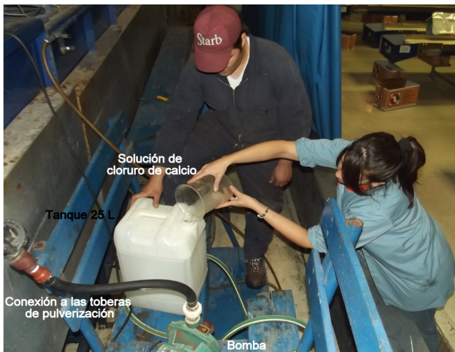
Figura 5. Detalle de tanque de aplicación, sistema impulsor y conexión al sistema de pulverización.
