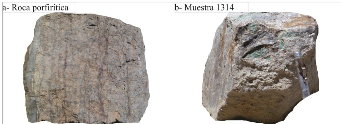
Fig. 11. a) Roca porfírica con venillas de cuarzo tipo sheeted , constituida por fenocristales de plagioclasa (10 mm- 0,258 \mu\text{m} ), minerales máficos (1mm a 280 \mu\text{m} ) y magnetita + apatito (50 \mu\text{m} ) como accesorios, en una pasta de grano fino (25- 40 \mu\text{m} ). b) Muestra 1314: Pórfido con fenocristales de plagioclasa y relictos de biotita en una pasta microgranular, atravesado por venillas de cuarzo.
