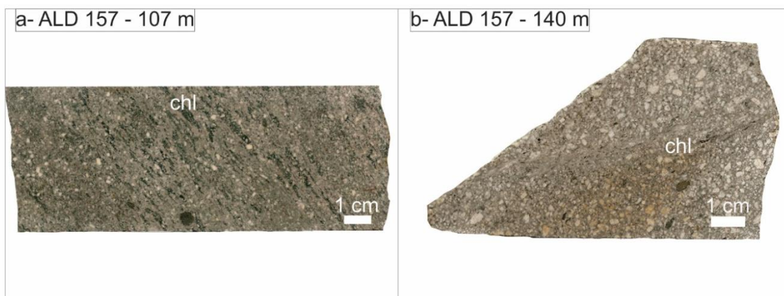
Fig. 19. a y b) Pórfido estéril con fenocristales de plagioclasa y minerales máficos en una pasta de grano fino, afectado por alteración propilítica caracterizada por el reemplazo de la plagioclasa por filosilicato y carbonato y el anfíbol a clorita. La pasta está reemplazada por cuarzo hidrotermal, rutilo reemplaza a opacos y se reconocen trazas de pirita. Abreviaturas minerales: Chl: Clorita.
