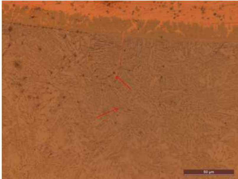
Figura 5.2: Microscopía óptica de la muestra M1 con ataque químico
