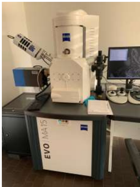
Figura 4.9: SEM ZEISS EVO-MA 15 utilizado.
