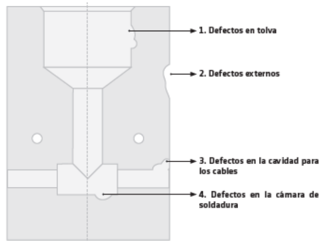
Figura 3.3: Posibles defectos en el molde de grafito para la soldadura cuproaluminotérmica [18].
