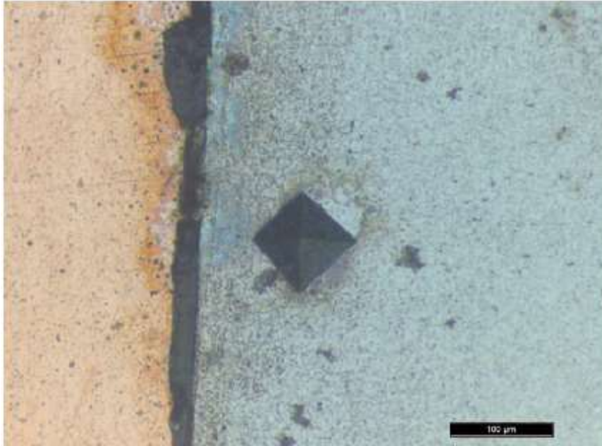
Figura 5.20: Micrografía de a muestra M8 en la zona de menor microdureza medida
