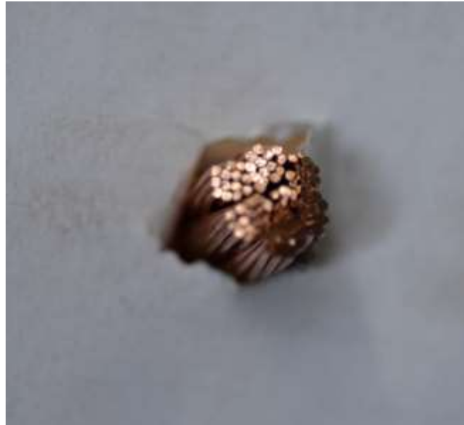
Figura 6.2: Cable conductor de 50mm 2 utilizado en el segundo PIP.
