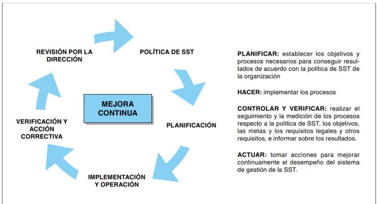
Figura 6. Modelo de sistema de gestión de la SST para el estándar OHSAS
