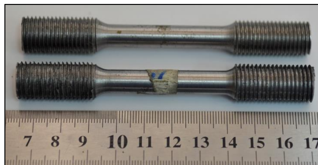
Figura 3.12: Probetas mecanizadas para tracción.
