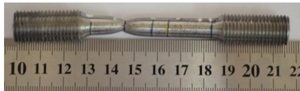
Figura 4.54: Probeta fracturada de acero AISI-SAE 4140 en estado original.
