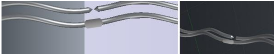
Figura 2.17: Disposición de los extremos del eje para soldar paralelo a un rotor de idéntica geometría.
