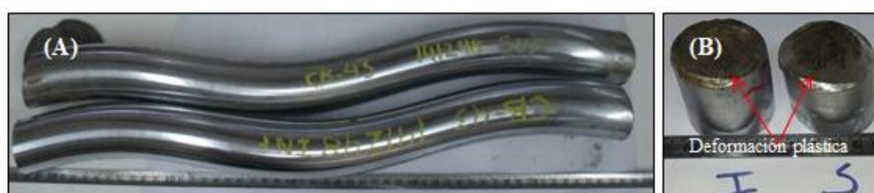
Figura 4.10: Rotor R2 fracturado.
