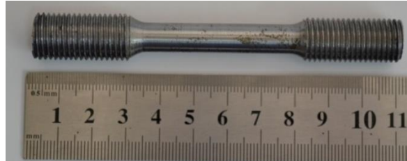
Figura 4.53: Probeta de acero AISI-SAE 4140 en estado original.
