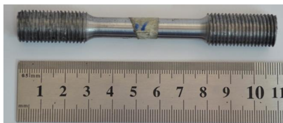
Figura 4.58: Probeta de acero AISI-SAE 4140 tratada térmicamente.
