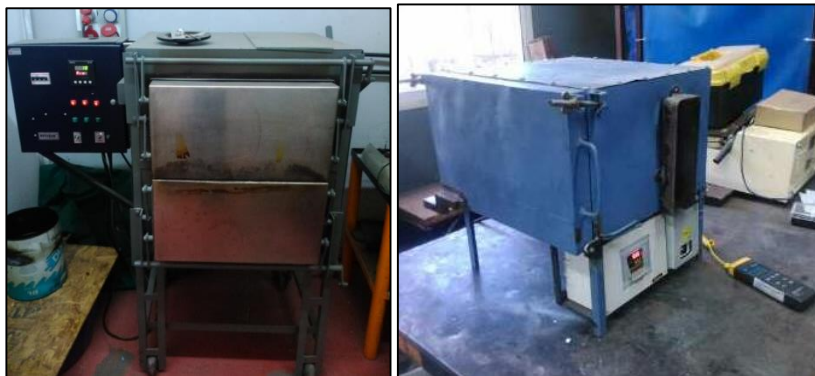
Figura 3.7: Hornos de resistencia eléctrica utilizados.
