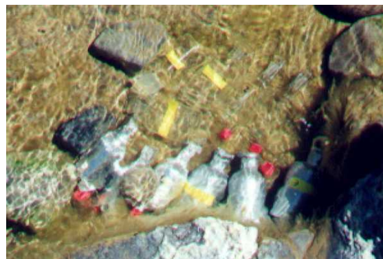
Figura 11: Vista de las botellas claras y oscuras empleadas para la determinación de CO 2 en el Río Agrio Inferior (Efluente).
