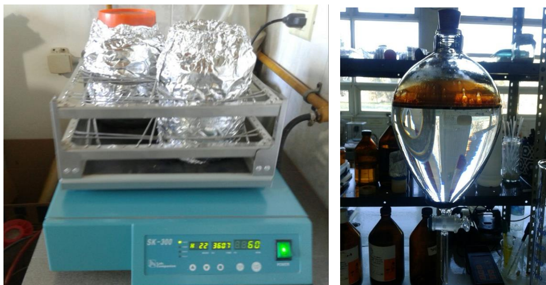
Figura 4.2: Preparación de la WAF. (Izq.) Mezcla de petróleo y agua en agitador. (Der.) Ampolla de decantación en la cual se observan las dos fases: petróleo (superior) y WAF (inferior).
