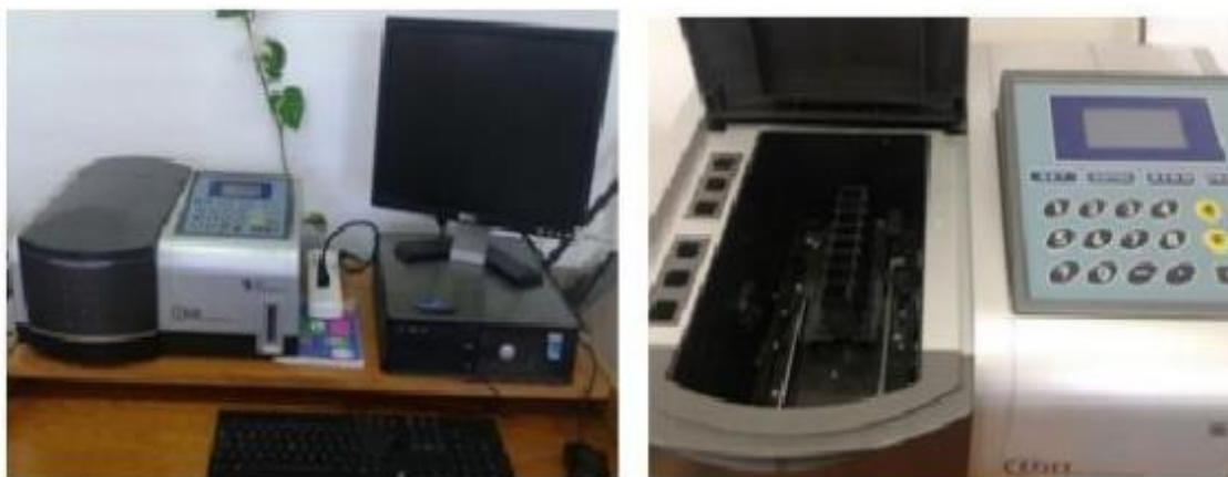
*Figura 19: Espectrofotómetro (extraído de Gamboa, 2018).*
