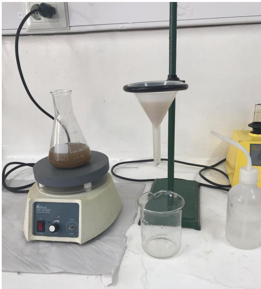
*Figura 51: Agitador y buzo en el proceso de lavado del material soporte.*
