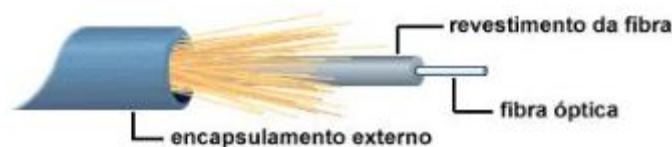
Figura 3. Esquema estructural de cable de fibra óptica.
