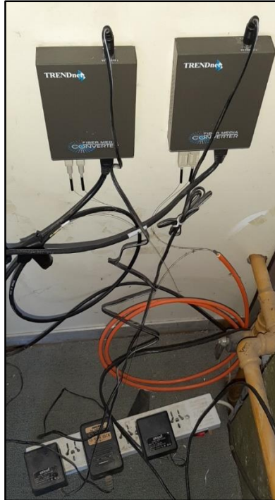
Figura 10. Media converter para conversión de FO a UTP.
