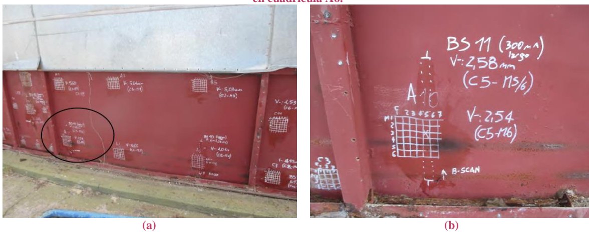
Figura 3.12: Ensayos sobre Chapa 18 de la Virola 1, (a) Vista general, (b) Detalle de cuadrícula A6, (c) Espesores en cuadrícula A6.
