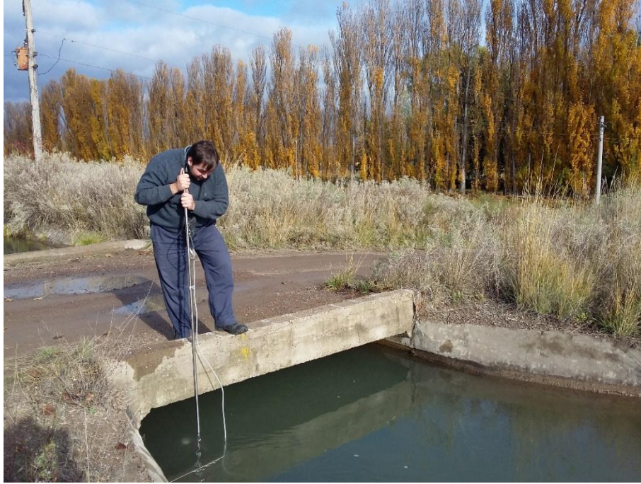
Imagen 8: Aforo del canal secundario VII. Fuente: propia.
