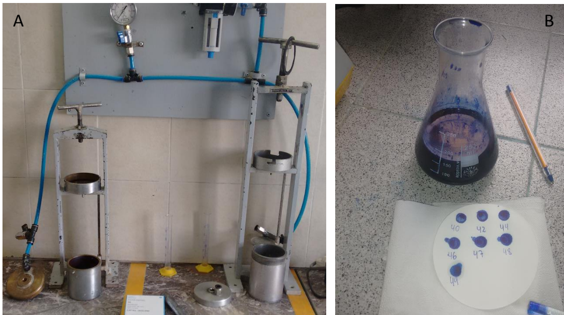
Figura 15. A- Filtros prensa para filtrado. B- Ensayo de azul de metileno
