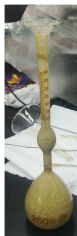
Figura 12. Ensayo de densidad
