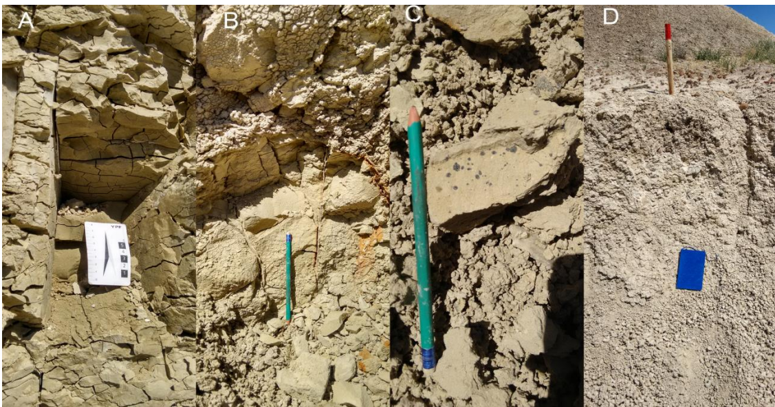
Figura 21. A- Bentonita del nivel inferior. B- Óxidos de hierro y grietas rellenas con yeso C- Óxidos de manganeso. D- Cubierta sedimentaria.
