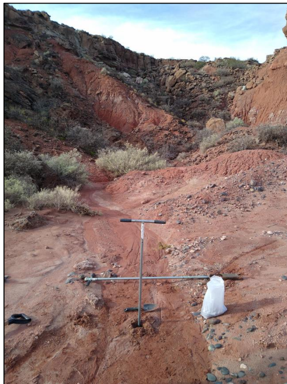
Figura 5.8. Sondeo con barreno y toma de muestra en el cauce de la cuenca C08
