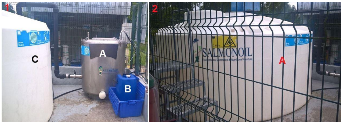
Fig.3. 1-2 Fotografía de estanque para mortalidad de salmón. 1:(A) Estanque triturador. (B): Depósito ácido fórmico (C): estanque acopio. 2: (A) Estanque de acopio.
