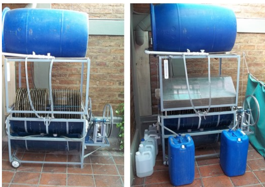
Figura 24 Izquierda: Fotografía de los reactores sin tapa; derecha: Fotografía de los reactores con tapa y los elementos utilizados durante la etapa experimental.
