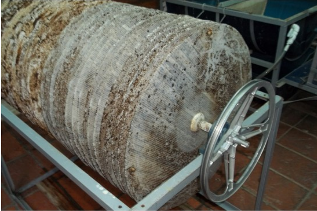
Figura 40 Fotografía de los discos huecos del RDH, luego de terminar la experiencia.
