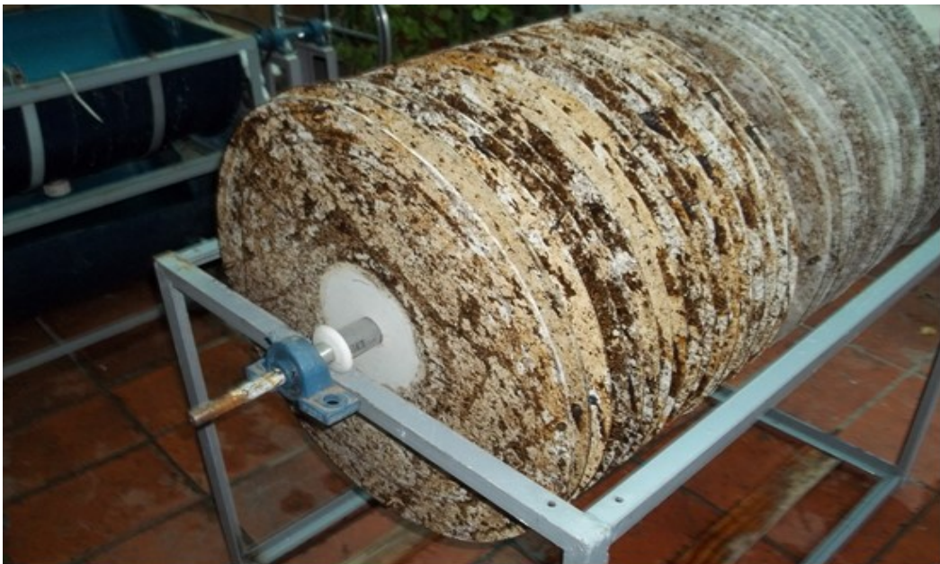
Figura 39 Fotografía de los discos sólidos del RDS, luego de terminar la experiencia.
