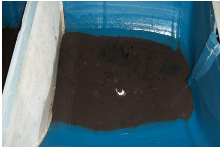
Figura 42 Fotografía del lodo decantado en el RDH al finalizar el estudio experimental.
