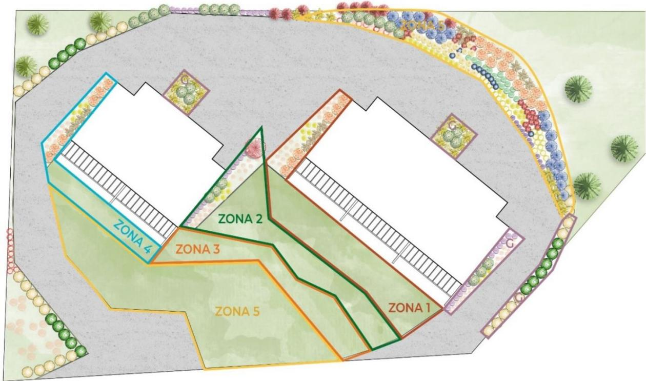
Ilustración 25: Diferentes zonas de riego por aspersión (1 a 5) y zonas de goteo (G).
