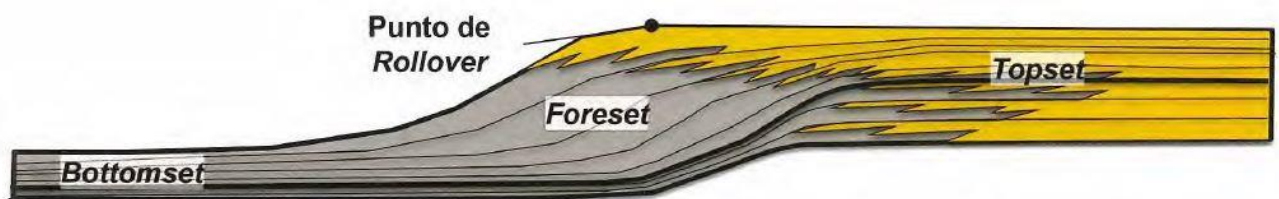
Figura 4 Segmentos de una clinoforma: Topset en la zona proximal con superficies casi horizontales, foreset en la zona central con mayor pendiente y bottomset en la zona distal con el desarrollo de superficies paralelas.
