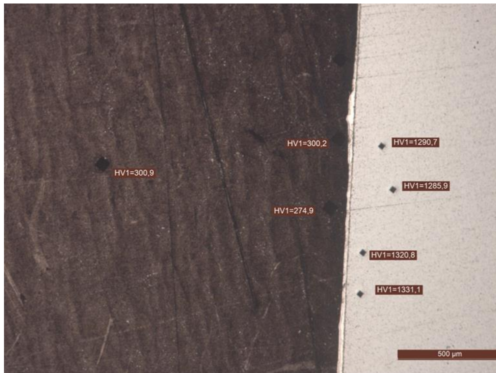
Figura 35 Improntas de medición de microdurezas en probeta M2B-5.
