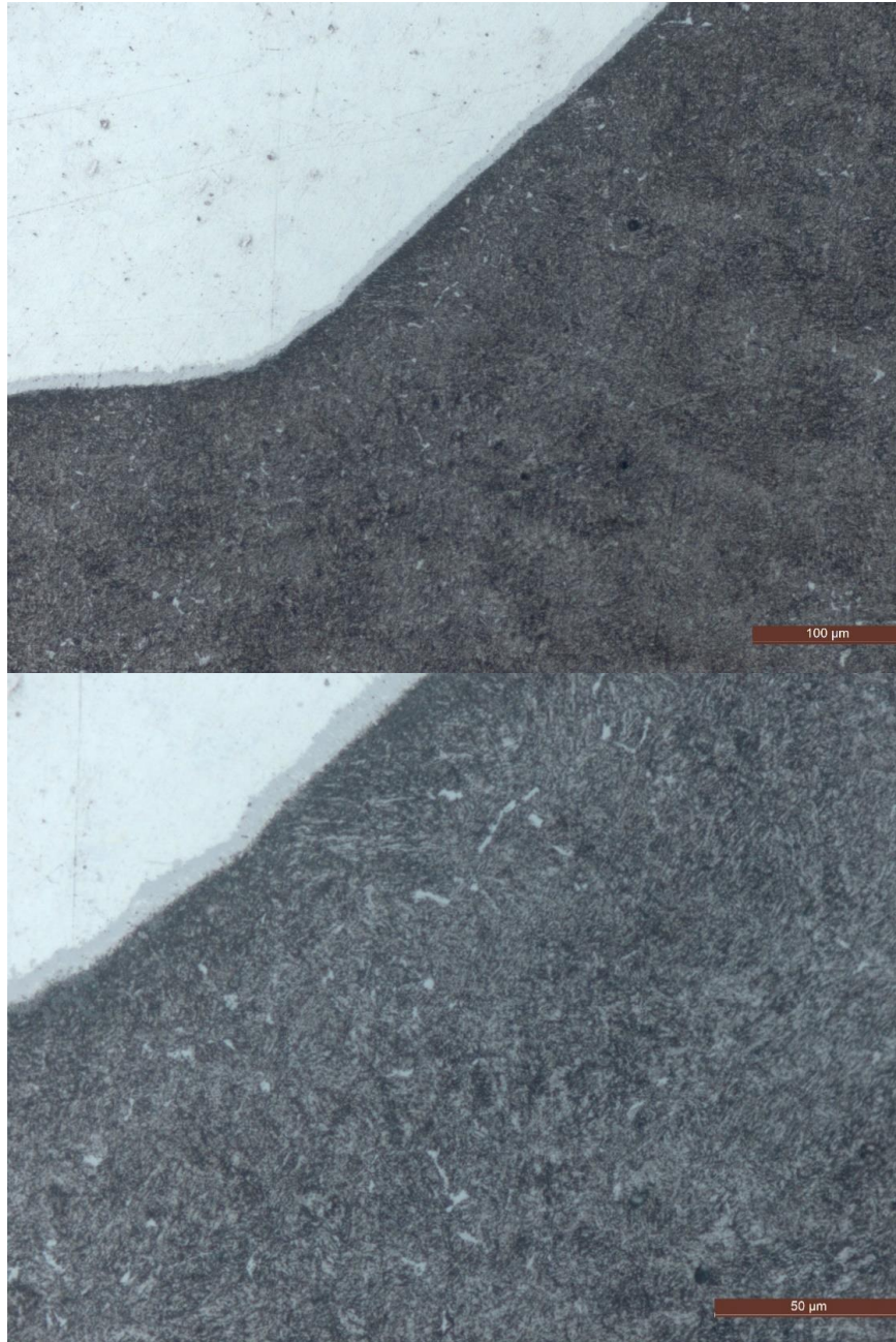
Figura 33 Microestructura en la matriz de la mordaza M2B 200X – 500X.
