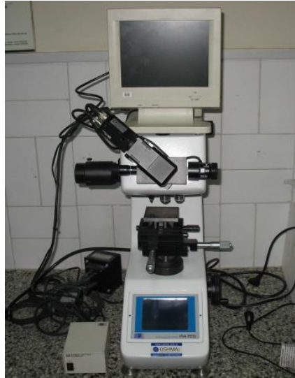
Figura 24 Microdurómetro Future-Tech modelo FM-700 utilizado.
