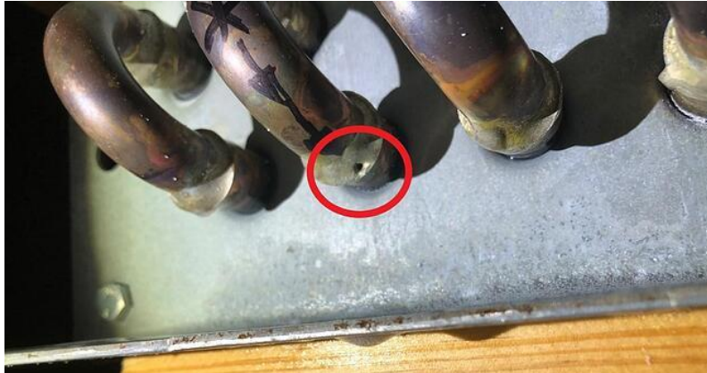
Figura 8 Fundente atrapado debido a un diseño de la junta no adecuado.
