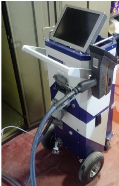
Figura 19 Espectrómetro de chispa marca FOUNDRY-MASTER Pro.
