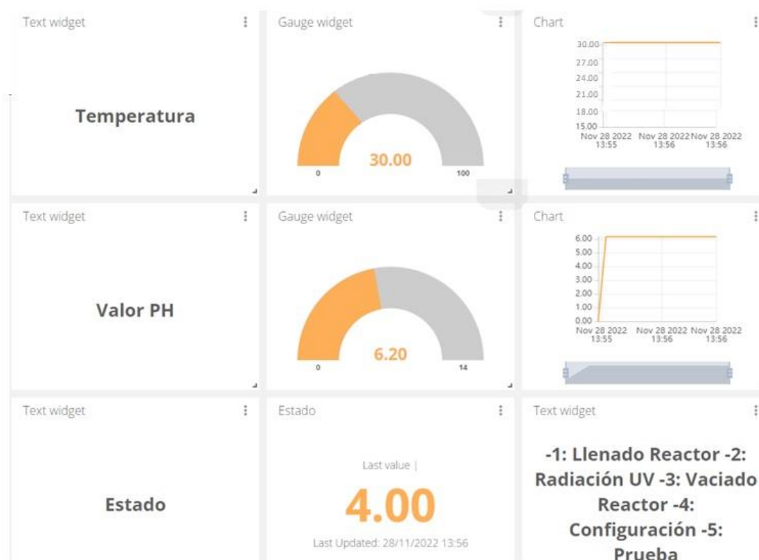
Figura 28: Interfaz a través del servidor web UBIDOTS
