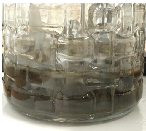
Figura 36: Solución de naranja G y nano partículas de Fe_3O_4 antes de la incorporación de H_2O_2
