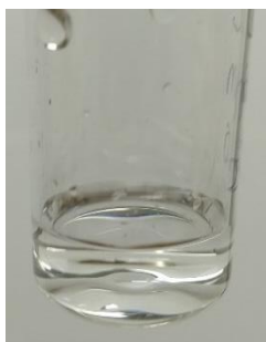
Figura 39: Producto del tratamiento finalizado de agua a pH 3 con nano partículas de Fe_3O_4 y de la separación magnética
