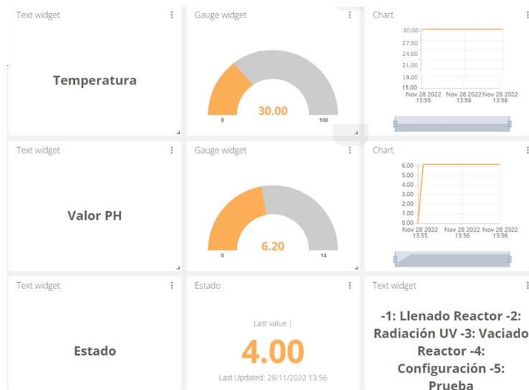
Figura 47: Dashboard del servidor web UBIDOTS
