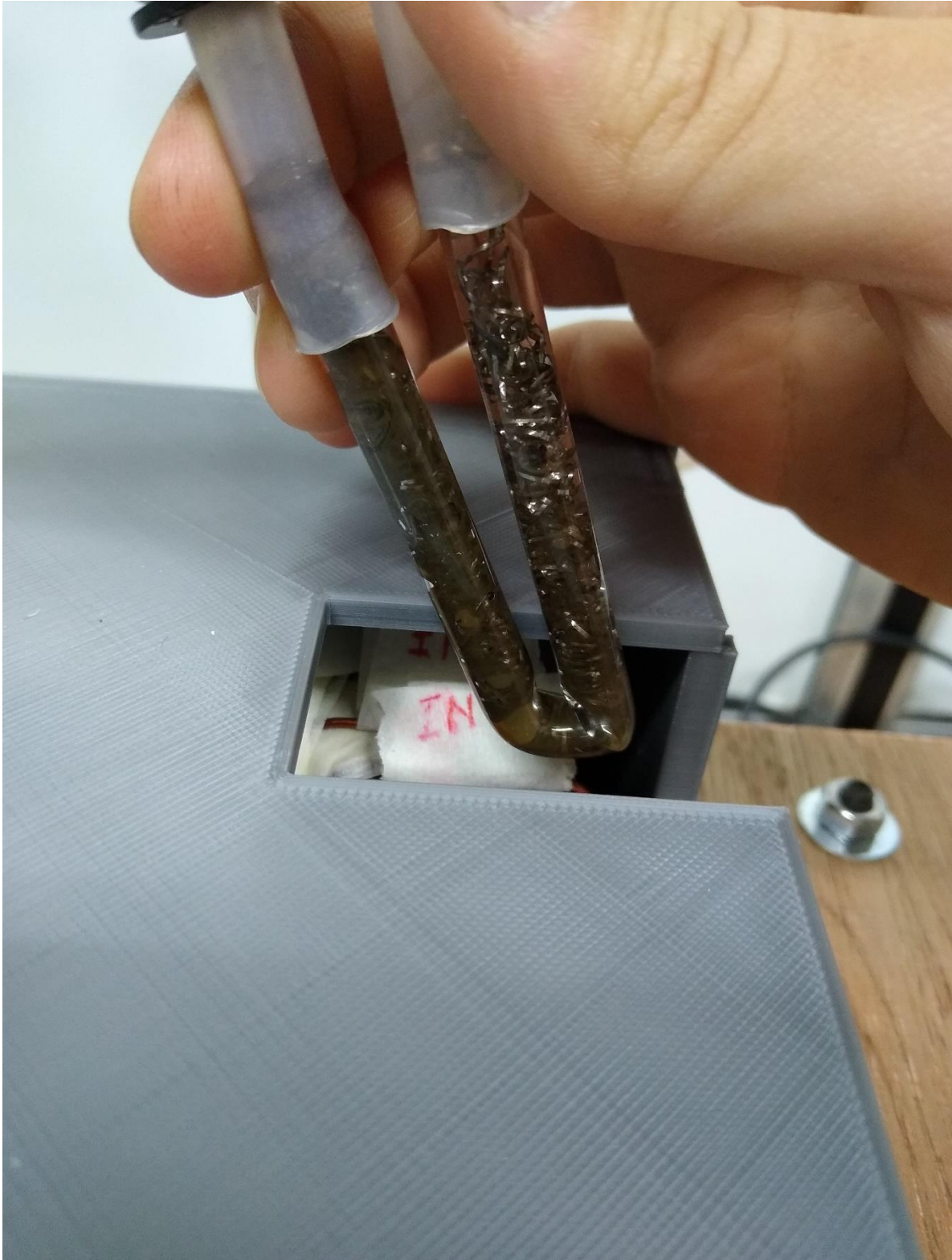
Figura 32: Recipiente contenedor de la lana de hierro para la separación magnética.
