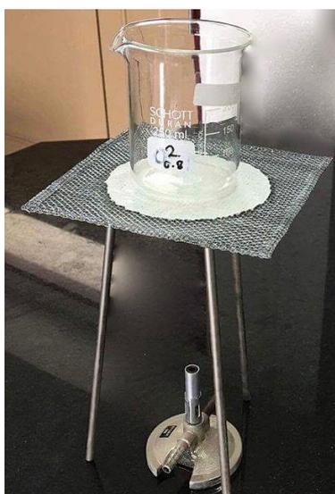
FIGURA 7: MECHERO BUNSEN, TRÍPODE, LÁMINA DE AMIANTO Y VASO DE PRESIPITADOS. FUENTE: HMONG.ES/WIKI/TRIPOD\_(LABORATORY)
