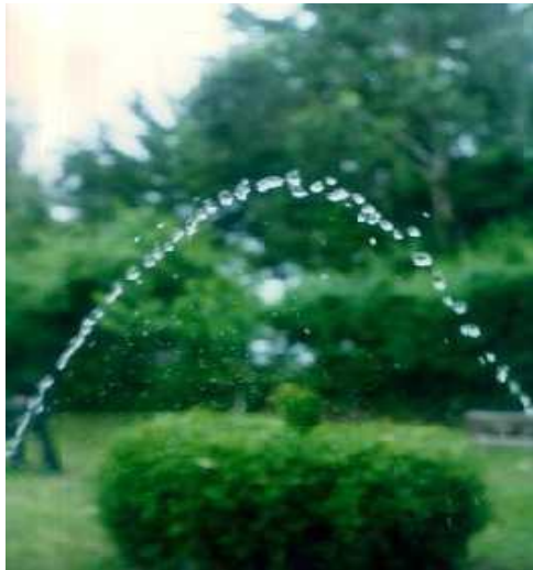
3. 5 Foto de la trayectoria del chorro de agua
