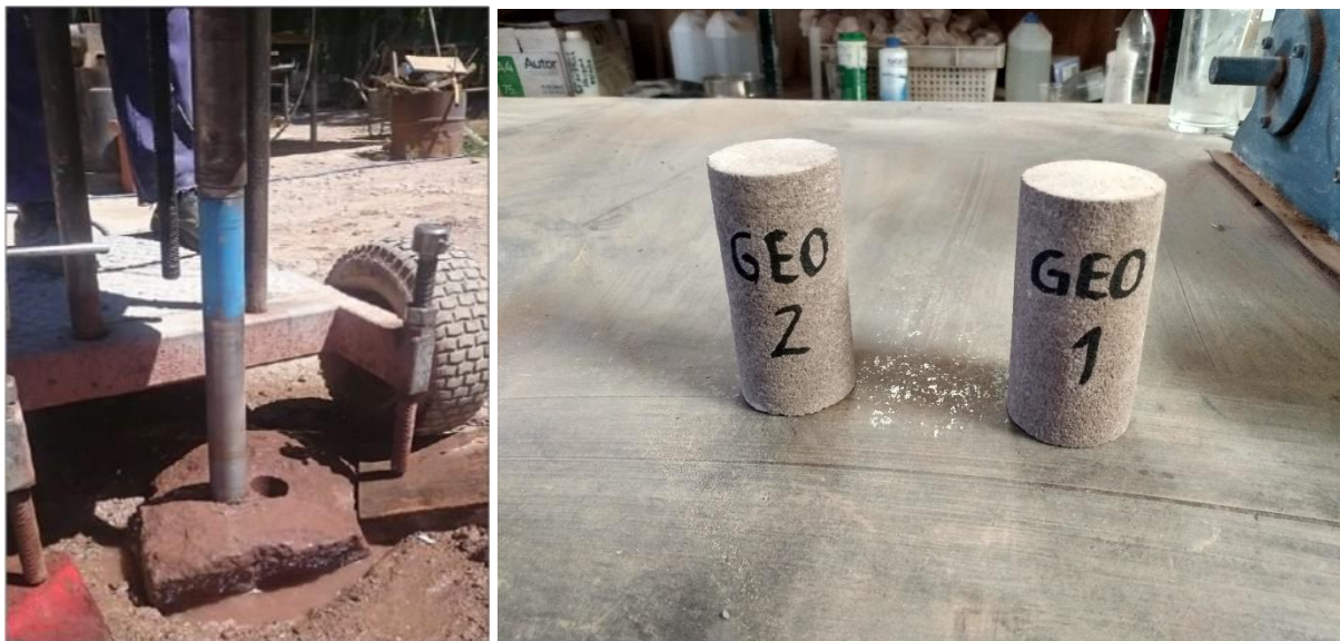
Figura 29: Extracción de las muestras para ensayo de compresión simple (izquierda) y muestras previas al ensayo (derecha).
