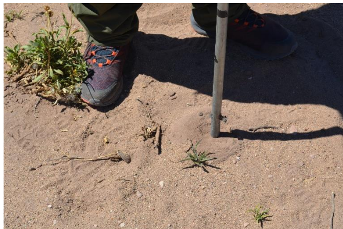
Figura 23: Extracción de muestra de suelo con barreno helicoidal.
