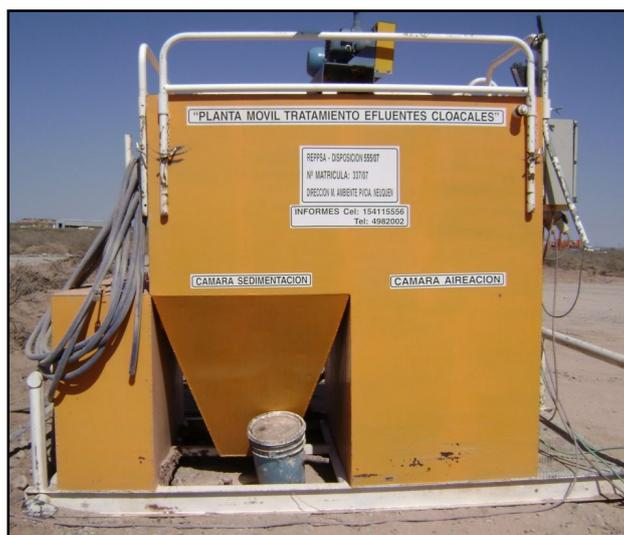
**Figura N°2.10:** Cámara de Sedimentación.
