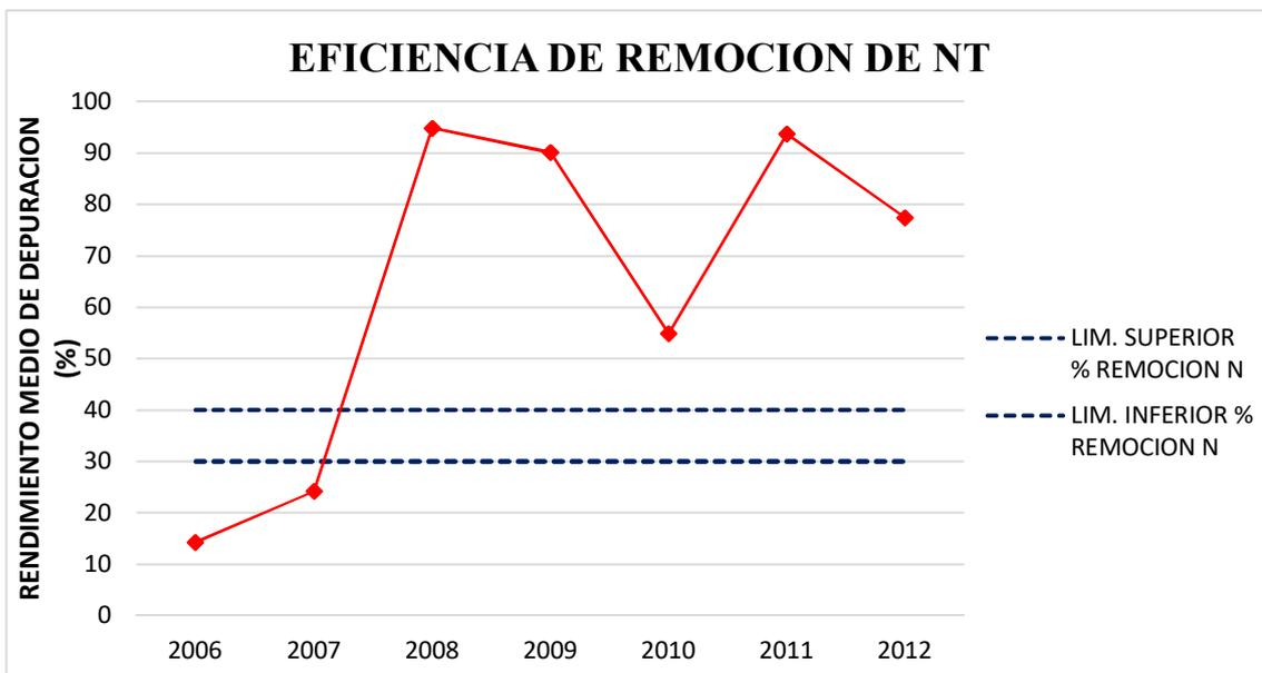
**Figura N°4.3:** Eficiencia de remoción de Nitrógeno Total (NT).
