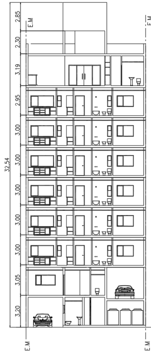
Figura 13 Corte transversal del edificio
