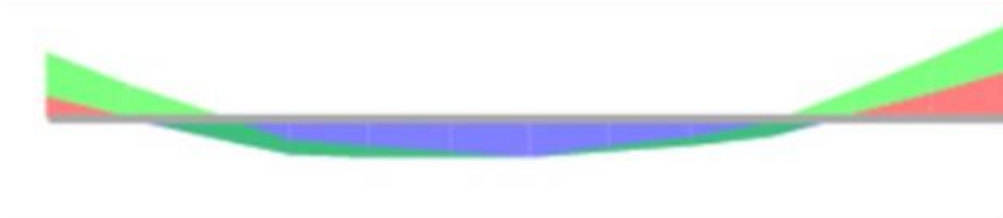
Figura 46 Forma típica de diagrama de momento flector para las vigas analizadas
