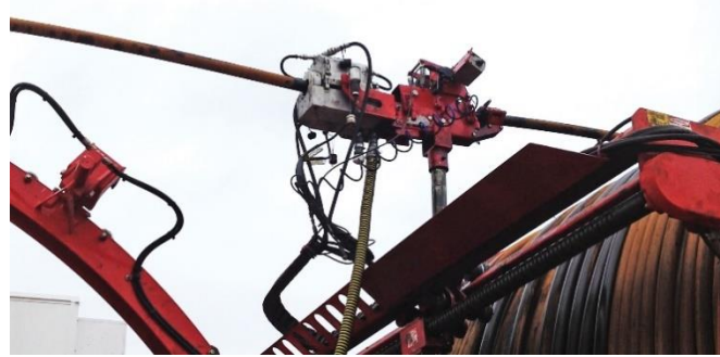
Figura N°41: Cabezal mecánico que incluye odómetro de tubería. https://www.drillingcontractor.org/real-time-capabilities-inspection-systems-fine-tune-coiled-tubing-21482
