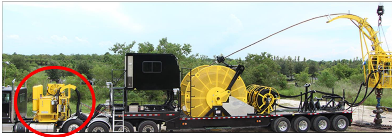
Figura N°32: Unidad de potencia integrada en el mismo patín de la cabina de control y montada en un patín independiente. https://www.energydais.com/stewart-stevenson/trailer-mounted-coiled-tubing-units-9323/
