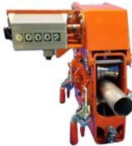
Figura N°41: Cabezal mecánico que incluye odómetro de tubería. https://www.drillingcontractor.org/real-time-capabilities-inspection-systems-fine-tune-coiled-tubing-21482
