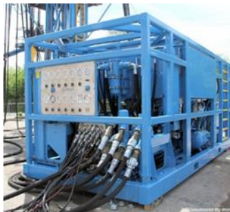
Figura N°31: Unidad de potencia sobre una plataforma con fuente de potencia independiente.
