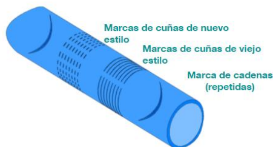
Figura N°24: Daños mecánicos de una tubería. Presentación de Schlumberger.
