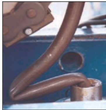
Figura N°57: Ejemplo de un C.T. doblado por ausencia de guía anti-pandeo. Cerberus for coiled tubing, 2012. NOV Nacional Oilwell Varco. Texas, USA.
