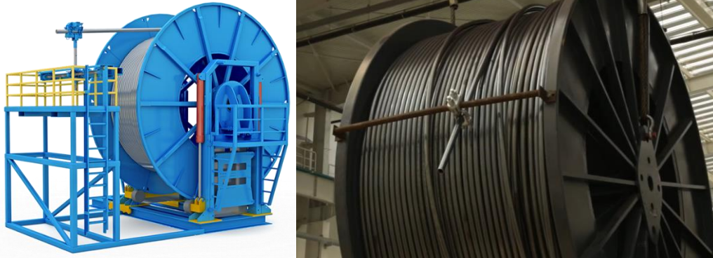
Figura N°70: Tubería enrollada en el carrete donde se aprecia la punta sin rosca. https://www.dwellop.no/product-portfolio/coiled-tubing-yard-spooler
