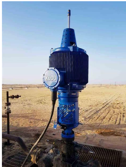
Figura 5-5: Motor imán permanente en PCP-Schlumberger (2020)- recuperado de https://www.slb.com/
