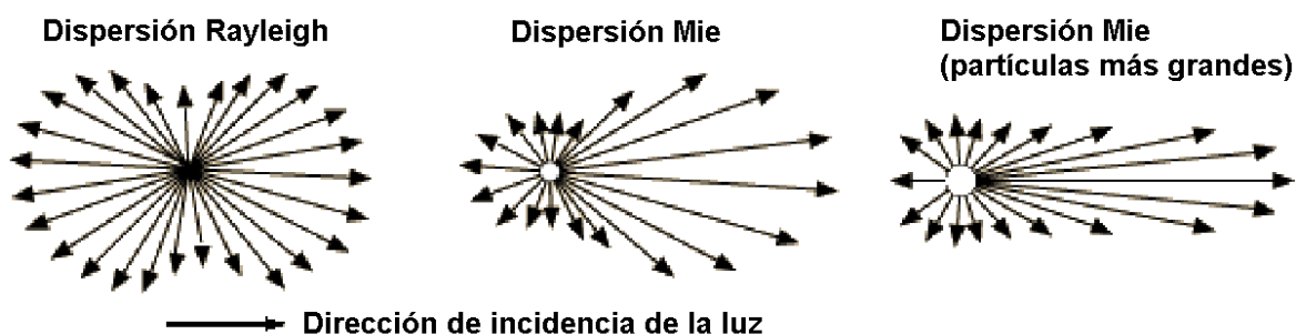
Figura 2.1.18 Características de las dispersiones Rayleigh (simétrica) y Mie (asimétrica) según el tamaño de las partículas.
