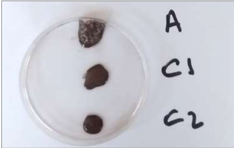
Figura 1: Arriba horizonte superficial con ligera efervescencia, al medio y abajo suelo más profundo sin efervescencia.
