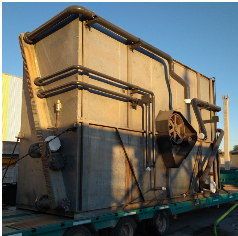
Figura 50. Aeroenfriador montado sobre remolque.
