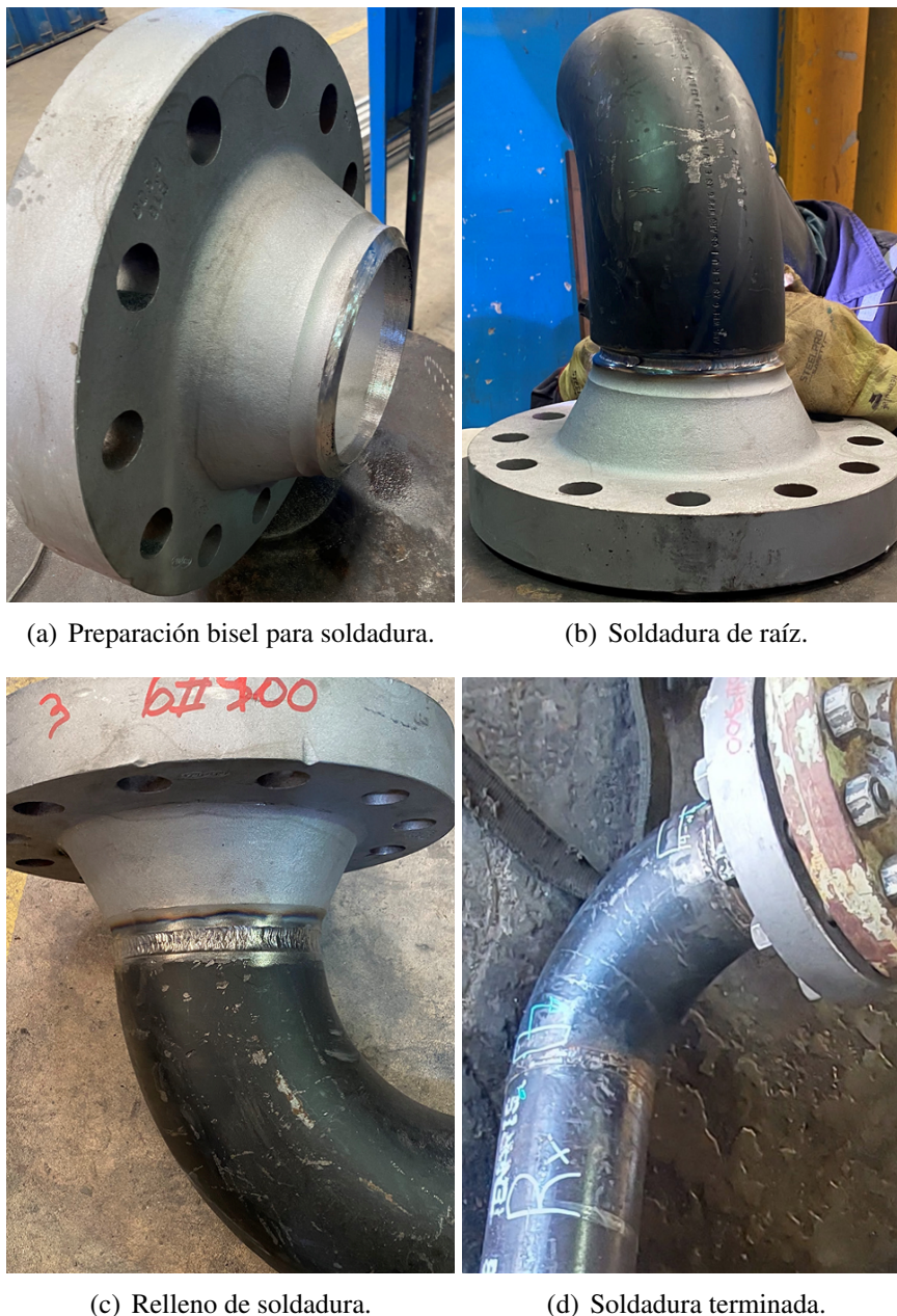
Figura 43. Detalle de ejecución de una unión soldada.
