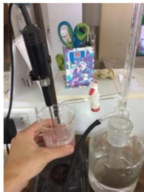
Figura 5: Titulación del jugo de peras con NaOH.
