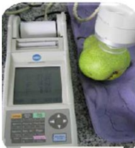
Foto 8. Medición del color de los frutos con colorímetro. Figura 13. Espacio de color CIELAB
