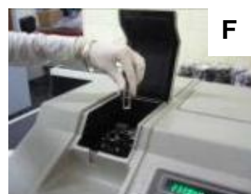
Se realizó la lectura del blanco (hexano puro) y de la muestra diluida sobre un volumen de 5 mL en cubeta de cuarzo
