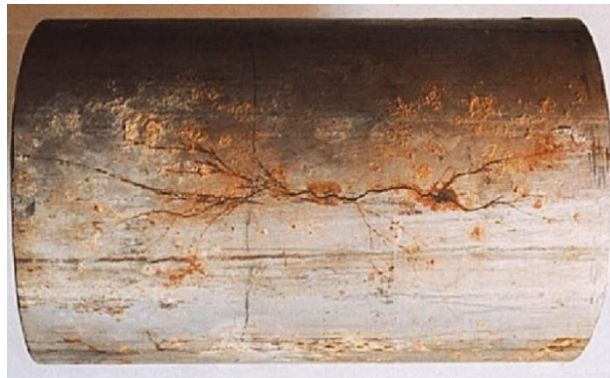
Figura 5: Ejemplo de corrosión bajo tensión
