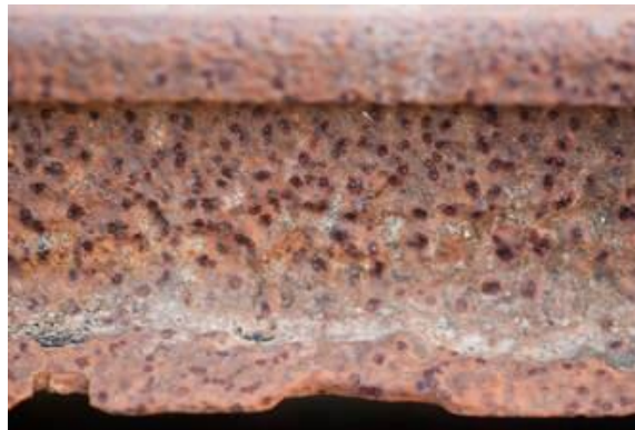
Figura 3: Ejemplo de corrosión por picaduras
