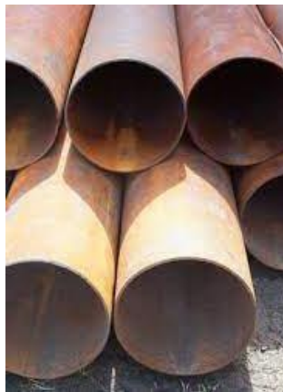
Figura 1: Ejemplo de corrosión uniforme
