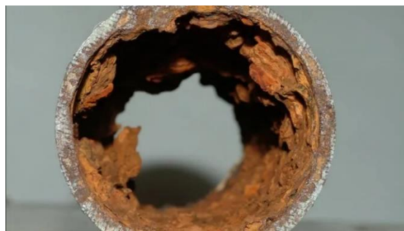
Figura 6: Ejemplo de corrosión microbiana
