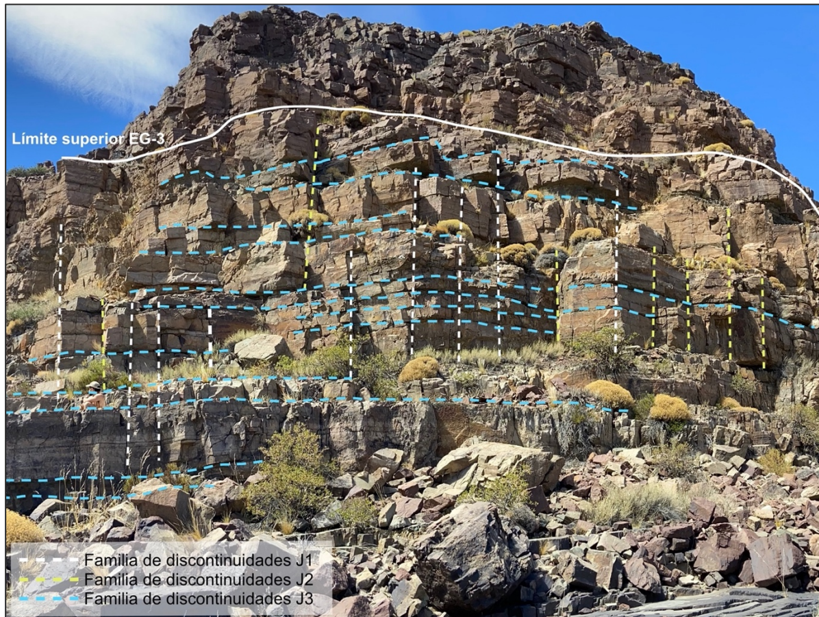
Figura 22. Disposición de las familias de discontinuidades identificadas en la estación geomecánica 3 (EG-3).
