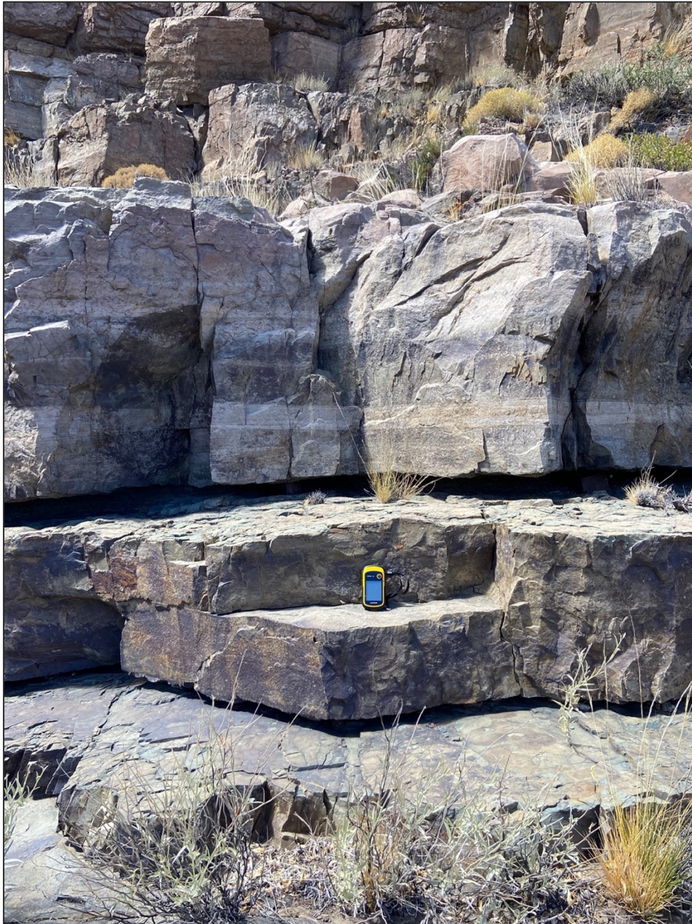
Figura 25. Diaclasas horizontales correspondientes a la familia de discontinuidades J3 con aberturas de hasta 3 cm y desarrollo de rugosidades escalonadas.
