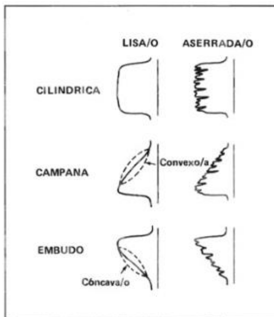
Figura 17: Clasificación de las curvas de los perfiles eléctricos GR y SP (extraído de Esquivel, 2020).
