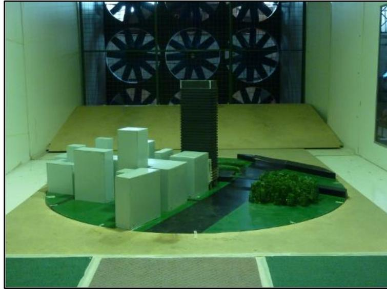
Figura 2.2: ejemplo de una simulación en túnel de viento físico
