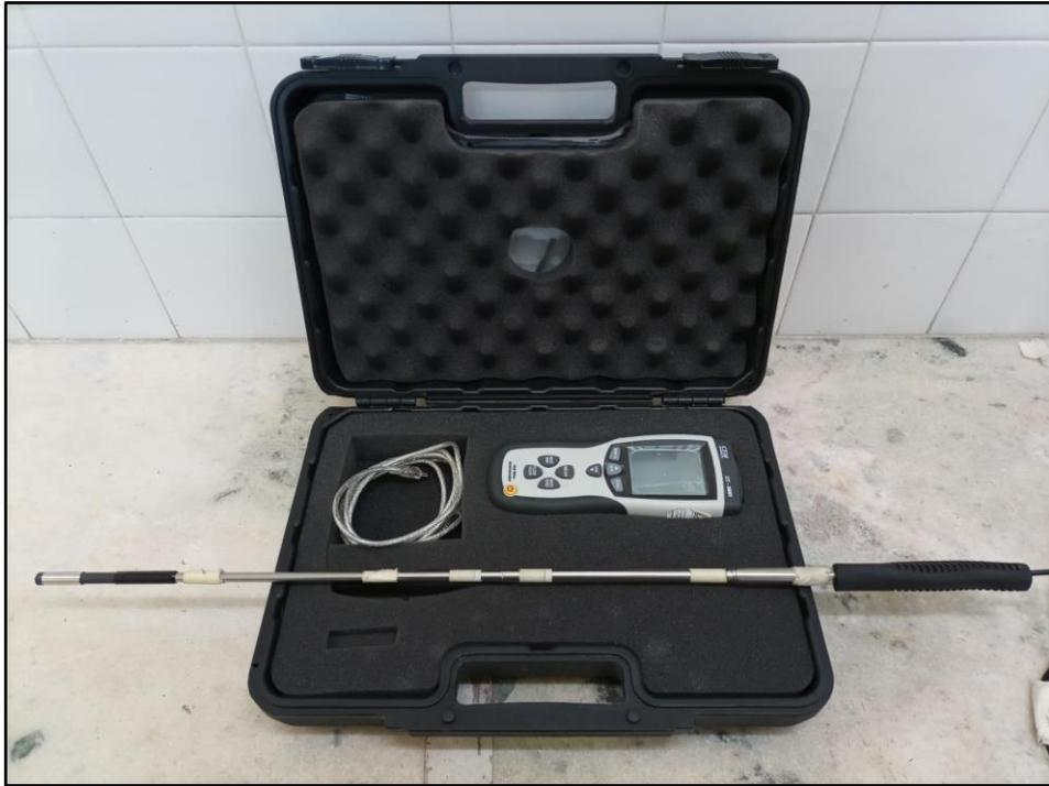
Figura 3.13: anemómetro de film caliente, CEM DT-8880, utilizando durante los ensayos para medir la velocidad dentro del túnel
