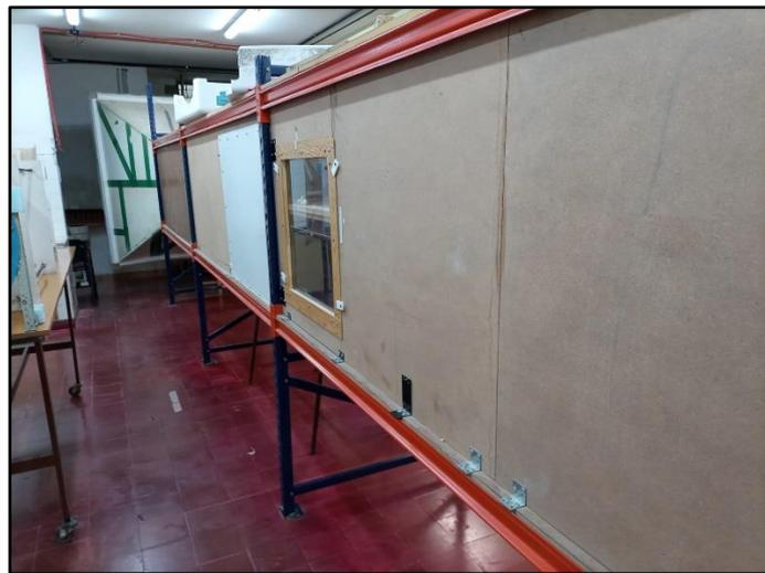
Figura 3.10: túnel de viento utilizado en el ensayo
