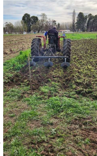
Imagen 3 – Aporcador/surcador para realizar estructuras de riego – Fuente: propia
