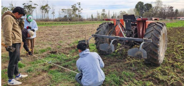
Imagen 3 – Aporcador/surcador para realizar estructuras de riego – Fuente: propia
