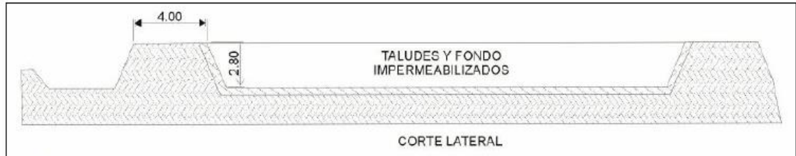
Figura N°1: Esquema general de las características constructivas de un repositorio.
