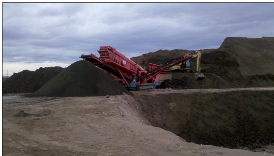
Foto N°10: Segregadora en operación.
