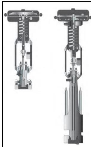
*Imagen 16: Válvulas de control de nivel. Manual Upstream YPF.*
