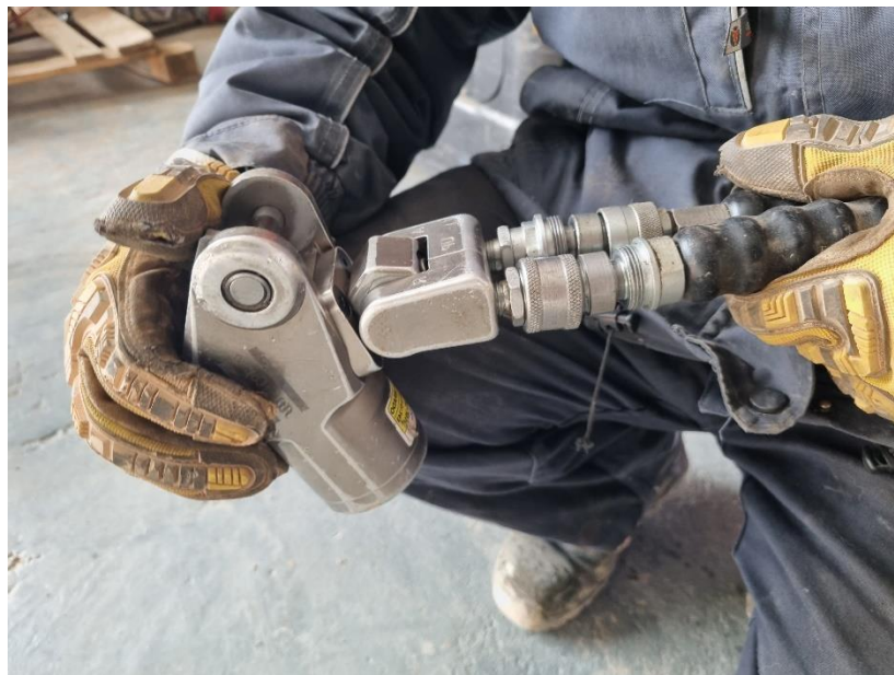
Imagen 20. Conexión de bomba. Fuente: Propia
