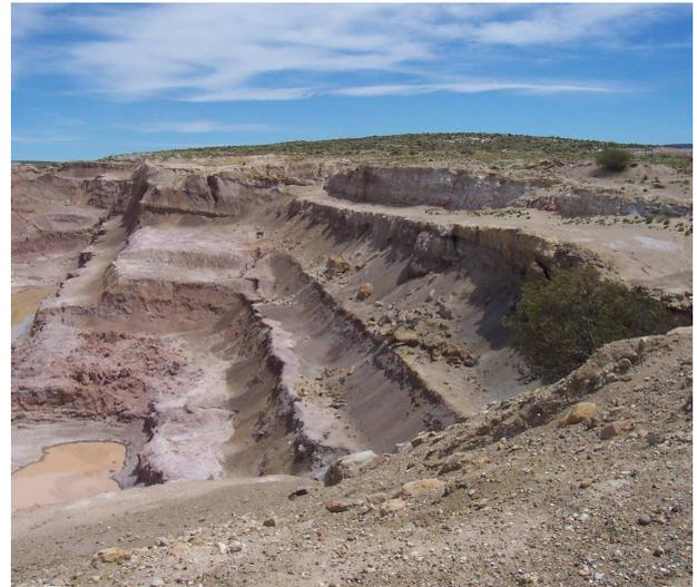
Figura 2: Labores de explotación a cielo abierto en la mina Misud
