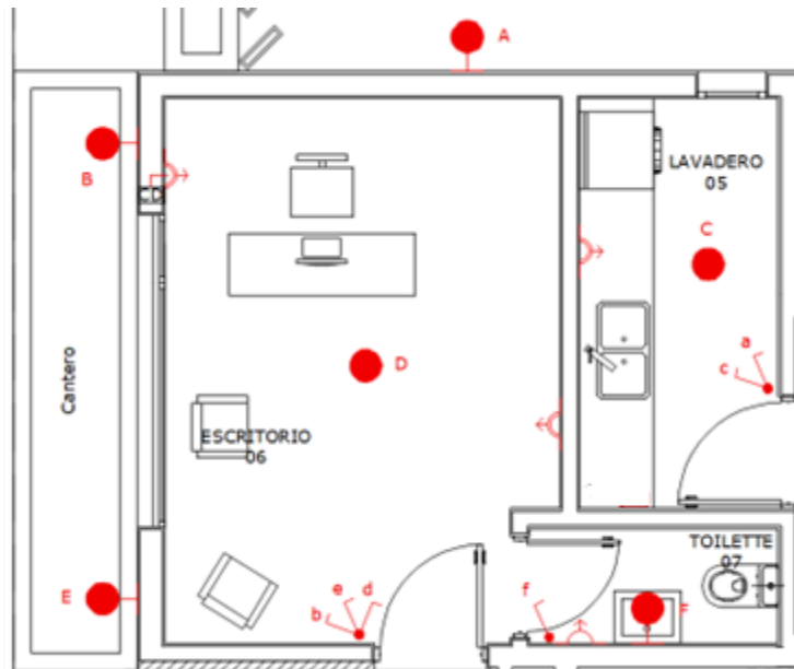
Imagen 68: Ubicación de bocas de iluminación y tomacorrientes en el local "Escritorio"
