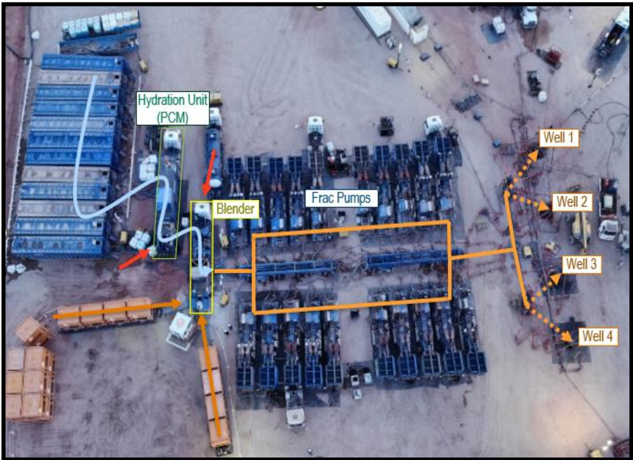
Figura 14. Distribución espacial en locación de los principales equipos utilizados para las operaciones de fractura hidráulica.
