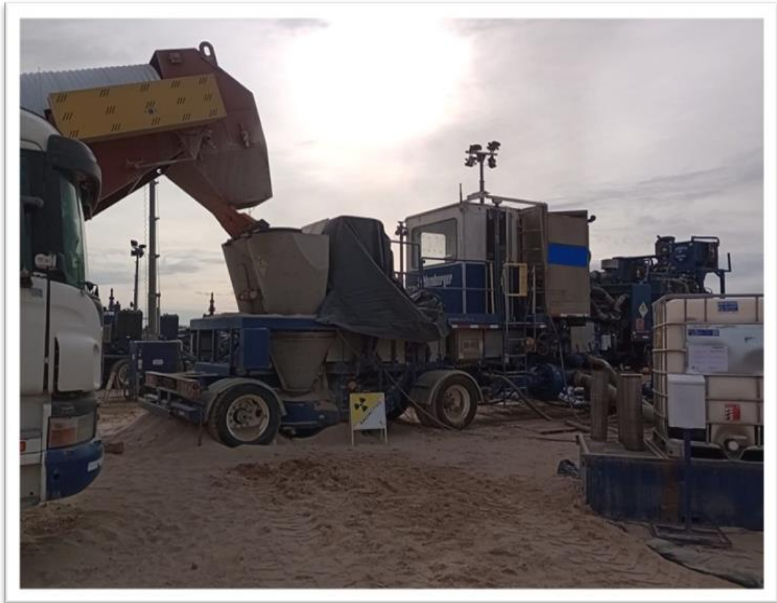
Figura 16. Mezclador ( blender ) del líquido, aditivos y agente sostén. Allí se forma lo que se conoce como fluido de fractura
