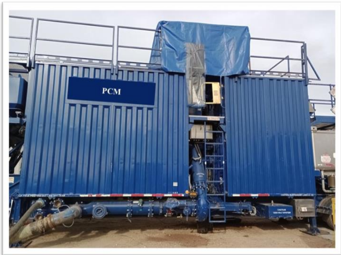
Figura 15. Equipo PCM en locación, donde se lleva a cabo el proceso de hidratación.
