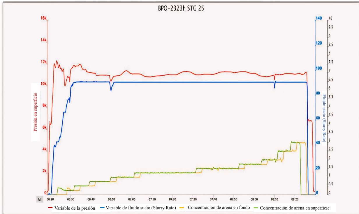
Figura 28. Monitoreo del desempeño del producto HVFR B en campo. Se representa la etapa 25 ensayada. En el gráfico la presión está representada con la línea roja, con azul se visualiza el caudal y las líneas de color verde y amarillo indican la concentración de arena en superficie y fondo.
