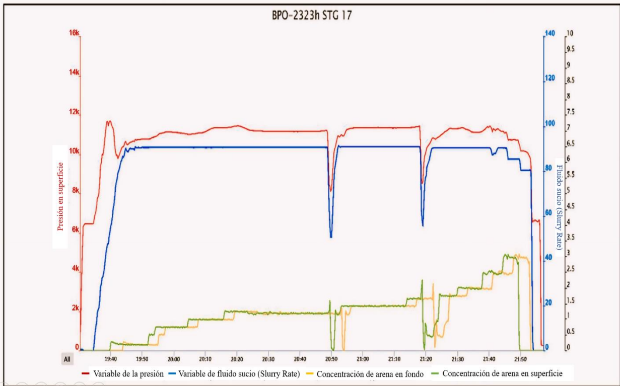
Figura 27. Monitoreo del desempeño del producto HVFR B en campo. Se representa la etapa 17 ensayada. En el grafico la presión está representada con la línea roja, con azul se visualiza el caudal y las líneas de color verde y amarillo indican la concentración de arena en superficie y fondo.
