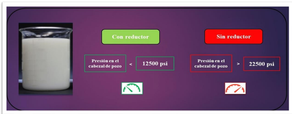
Figura 11. Diferencia de presión al bombear con reductor de fricción o sin reductor.
