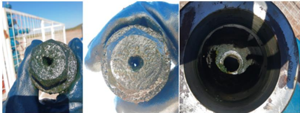
Esquema 3: Fotografía de Caja Porta orificio desarmada con parafina
